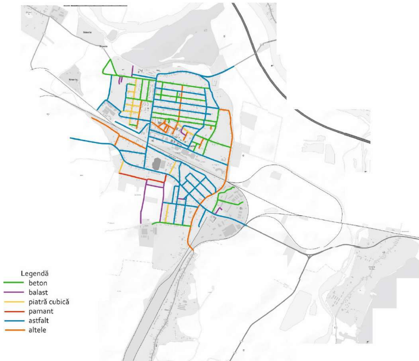
FIGURĂ 2-18 TIPURI DE IMBRACAMINTI RUTIERE PENTRU REȚEAUA STRADALĂ DIN ORAȘUL SIMERIA
